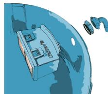
Coloque las piezas del sistema de auto-llenado en el orificio del depósito de agua prefiltrada. Conecte la manguera a la entrada de agua del tanque y el otro extremo a la toma de agua.
