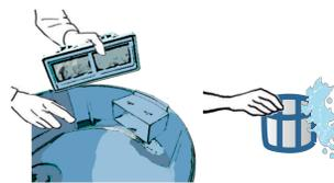
Retire el prefiltro de malla de la caja del sistema de auto-llenado o en caso de usar el sistema de llenado manual retire el prefiltro de malla y lave únicamente con agua por ambos lados
