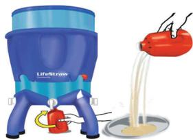
Después de realizar el retrolavado tome el recipiente rojo de salida de agua sucia sin purificar y deseche el agua de forma apropiada
