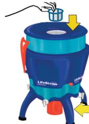
Coloque el prefiltro de malla presionandolo hacia abajo con cuidado y cubra con la tapa. Coloque en la salida de agua sin purificar (de abajo) el recipiente rojo de salida de agua sin purificar
