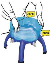
Una el depósito para agua purificada con la base
