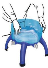
Lave con cloro diluido en agua y agua purificada el depósito para agua purificada, enjuáguelo perfectamente y coloque nuevamente el depósito para agua prefiltrada. (hasta que haga click) Nunca deje destapado por mucho tiempo el depósito de agua purificada
