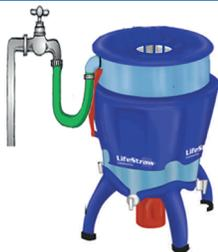
Abra la toma de agua para iniciar el llenado (El sistema de auto-llenado controla automáticamente la entrada y salida de agua)
